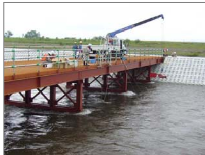
土研型掃流砂採取器試験風景
