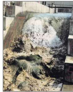
研究事例3) 合理的な堤防強化技術の検証 土木研究所二次元破堤実験状況 (土木研究所パンフレットより)
