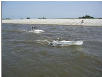
杖ワイヤー式ADCP観測船とRC-ADCP観測船風景
