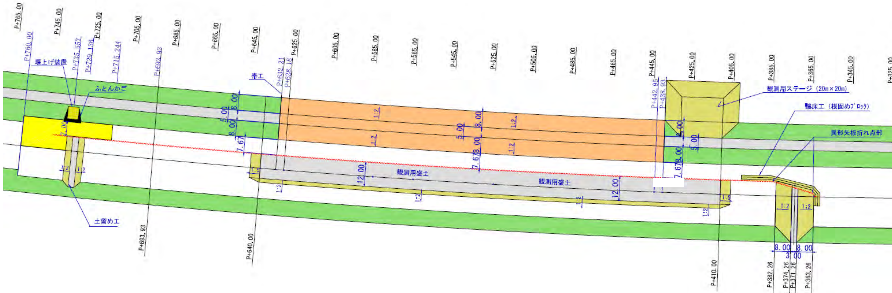
図-1 実験水路平面図 実験区間の護岸は保護、切欠き部なし
