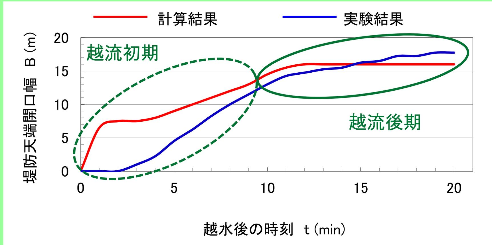
越流初期は計算結果において急激な破堤口の拡大が見られる
