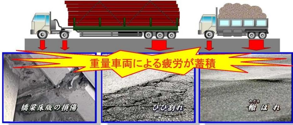
車両の重量による道路構造物の疲労に及ぼす影響は、それぞれ、舗装で4乗、RC床版で12乗といわれています。
