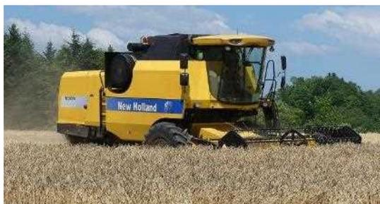
真狩村コンバイン運行組合では、事業実施後の平成 31 年に大型の小麦コンバイン（刈幅 4.3m、馬力 258ps、タンク容量 8,000ℓ）を 1 台導入している。
