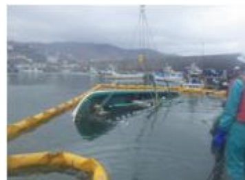
越波による漁船沈没状況
