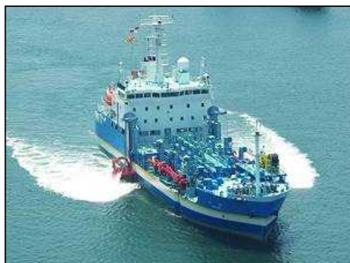
大型浚渫兼油回収船「白山」
