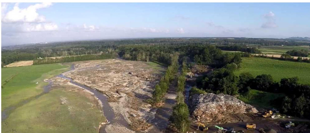
農地・排水路の被災(清水町:農地への土砂等の流入、護岸・法面の流失)
