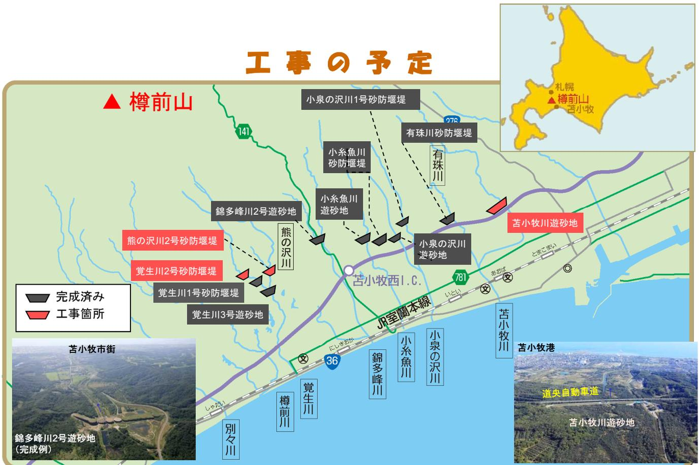
火山が噴火した時に泥流をせき止め貯める施設や、災害時に現地対策基地として利用する施設を整備しています。
