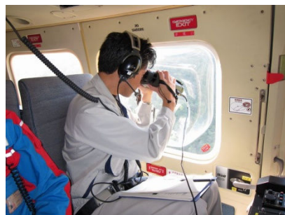
ヘリから河道閉塞を レーザー距離計により計測
