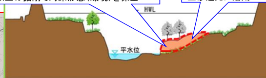
河道掘削(多自然川づくり)
