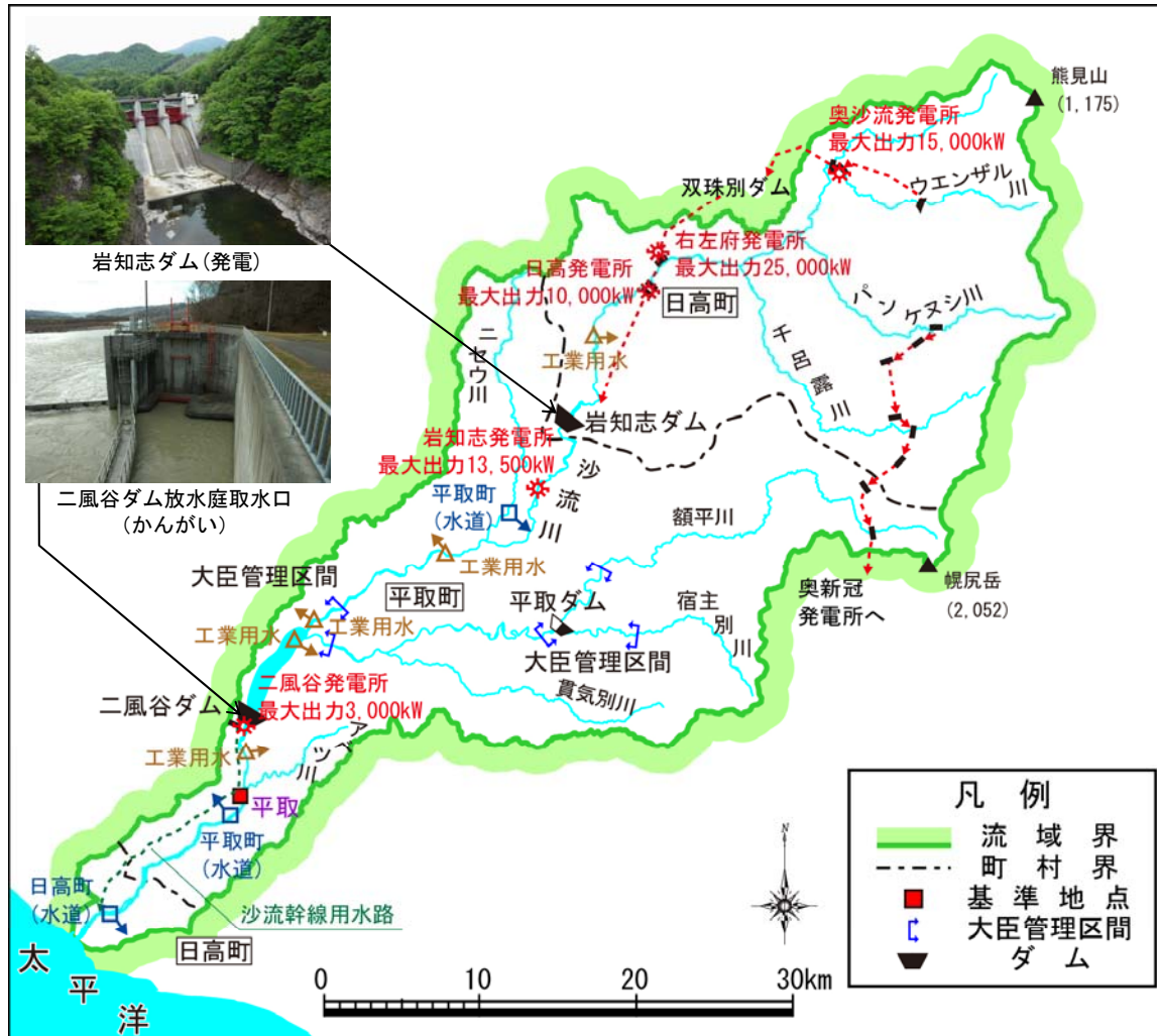
沙流川の取水排水系統図
