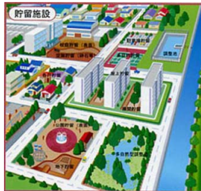
雨水貯留施設整備のイメージ
