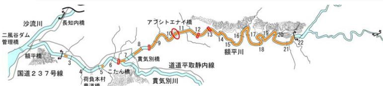
○パブリックコメントを踏まえて追加する治水対策案①（ダムの有効活用（二風谷ダム掘削＋岩知志ダム（掘削＋容量買い上げ）＋奥沙流ダム（掘削＋容量買い上げ））＋堤防のかさ上げ＋河道の掘削）
