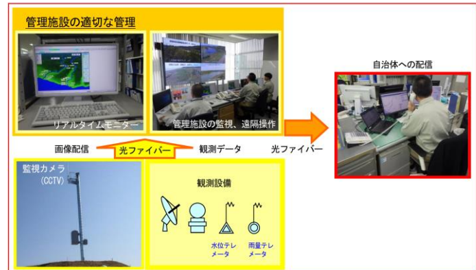
図 2-5 光ファイバー網による河川情報の収集・伝達のイメージ図
