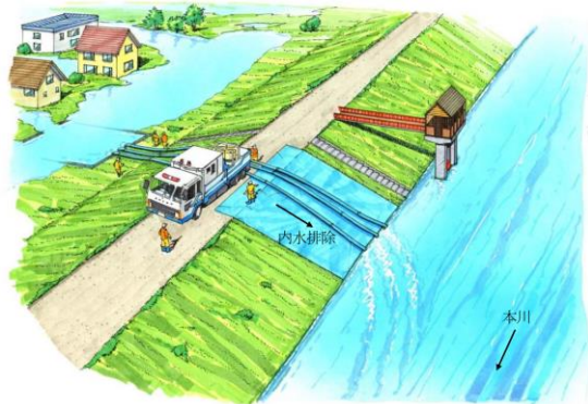
図 2-4 内水排除のイメージ図
