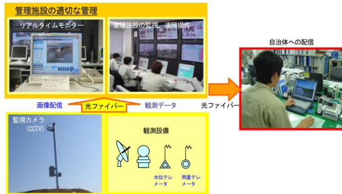
図 2-6 光ファイバー網による河川情報の収集・伝達のイメージ図
