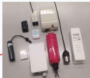
実証実験に用いている浸水センサ
