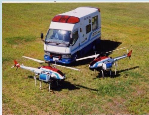
ラジコンヘリコプター、移動操作車で構成されており、有人飛行が制限されるような危険区域内にて災害の状況及び被災範囲などを迅速に調査することにより災害対策や応急復旧作業に有用な情報収集を目的とした機械です。
