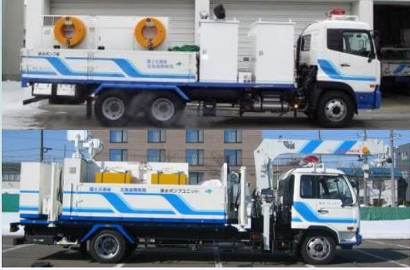
本機械は、洪水災害時において排水作業を行う機械です。排水ポンプ・発動発電機・照明装置・クレーン装置等を搭載しており、ポンプ設置から排水作業までの作業をこれ1台で行うことができます。
