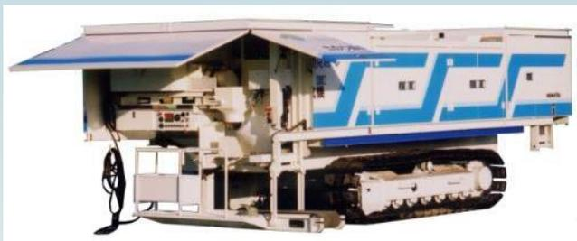
洪水時における堤防の漏水などを防ぐため行われる土のう積工法に使用する土のうを迅速且つ大量に作成することができる機械です。
