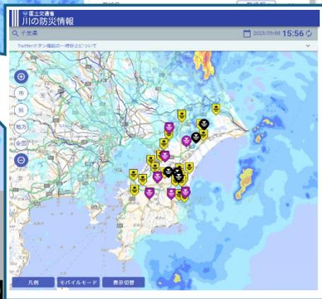
普通的水位計と同じタイミングで危機管理型水位計が表示されるように改善し、見落としを防ぐことができる。
