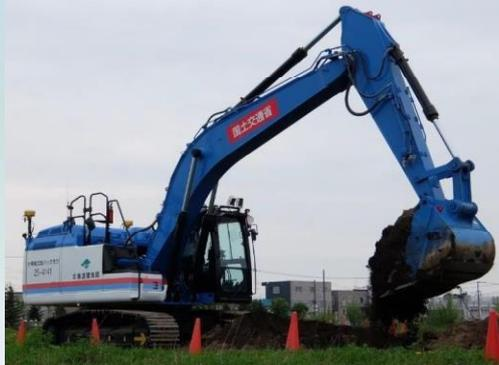
分解組立型バックホウは、災害等による通行経路寸断により被災現場に機材が投入できない場合に、空輸での運搬対応可能な分解組立式の機械です。また、災害現場でのオペレータの被災防止を目的とした遠隔操作機能も搭載しています。
