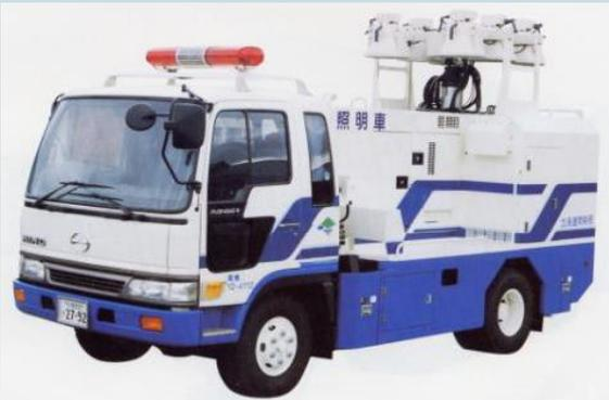
照明車は、発動発電機・照明装置を搭載しており、夜間における照明作業に使用することが出来ます。
