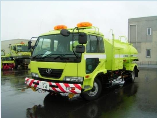
本機械は、国道の散水作業に使用する散水車に給水装置を搭載することにより、給水活動にも利用できる構造となっているほか、各種施設の給水タンクなどに水を圧送する機能も備えています。近年では、H30年に安平町・厚真町からの要請を受け、町内各所の給水所に対し給水活動を行いました。
