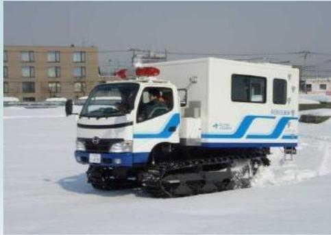
ゴム製無限軌道（履帯）を装着することにより、一般車両では走行が困難な沼地・雪上などの不整路面の走行が可能な災害対策用機械です。
