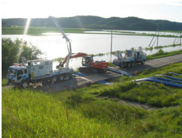
十勝川 豊頃町安骨地先 排水ポンプ車稼働状況 平成15年8月10日午前撮影
