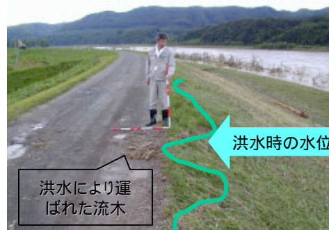
二風谷ダム下流の洪水痕跡
