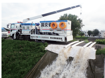
排水ポンプ車による排水支援(帯広市)
