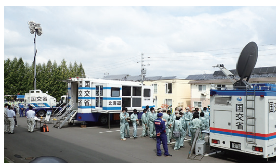
帯広工業高校での災害対策用機械を用いた防災教育(写真左から照明車、対策本部車、衛星通信車)
