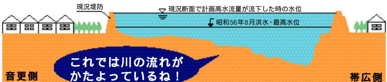
計画高水流量とは、堤防を計画したときに最大に流せる水の量です。
