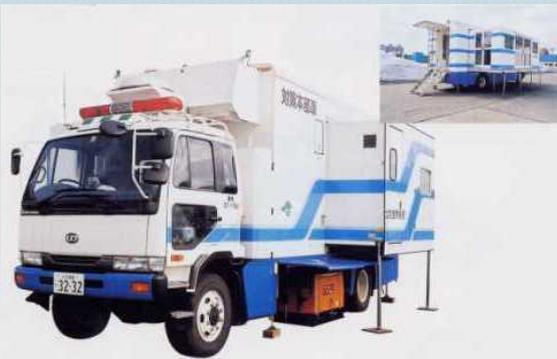
対策本部車は、災害発生時に速やかに出動し、現地における応急対策の指揮・連絡、情報収集及び伝達を担う現地対策本部機能を確保するための災害対策用機械です。
