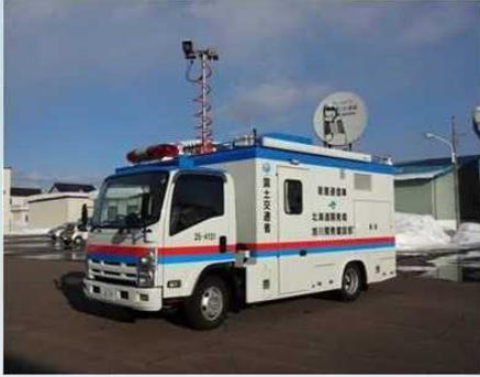
衛星通信設備を搭載しており、現地における通信確保及び車載カメラによる情報収集等、発災現場における情報通信の中心となる機械です。
