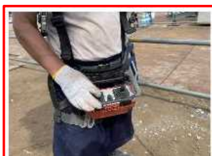
(写真：左) ジョイスティック式 リモコンで、旋回・前後、 吊上・吊降しを操作
