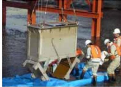
バケット式掃流砂採砂器
