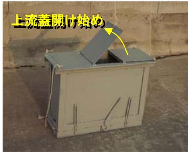
バケット式掃流砂観測装置
