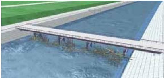
千代田実験水路での流木捕捉実験イメージ図
