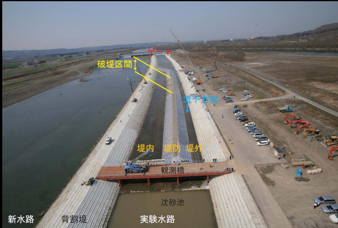
水路内に縦断堤(高さ2.5m、天端幅3m、法勾配2割)を造成し、横越流による破堤実験を土質を変えて2回行った
