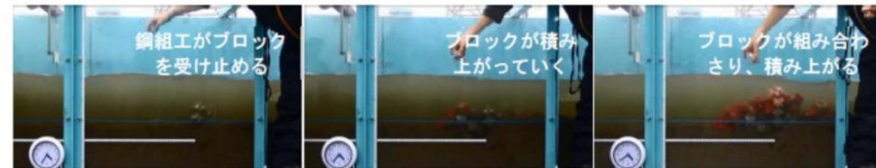
写真 2.14 鋼組工の模型実験の状況
