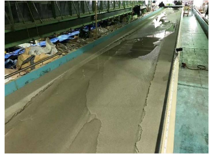
○模型による河川蛇行実験の例
