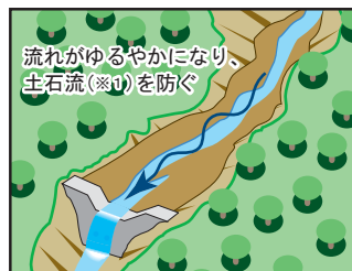
土砂がたまと流れ下る土砂の勢いがゆるまり、上流側では川の周りがけずられにくくなる。
