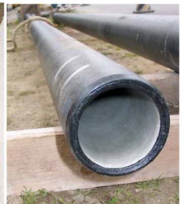
管の内側に塗装してあり、さびるのを防ぐ。
