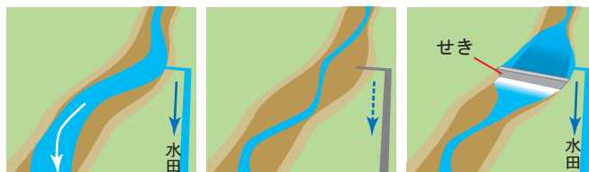
川から水田に水を引く。水が少ない時や流れが変わると引けない。せきをつくると、いつも水を引きやすい。
