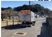
（空洞探査車による調査）
