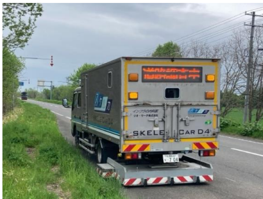
路面下空洞調査状況
