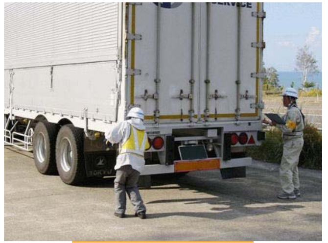
次は全幅を計測します
