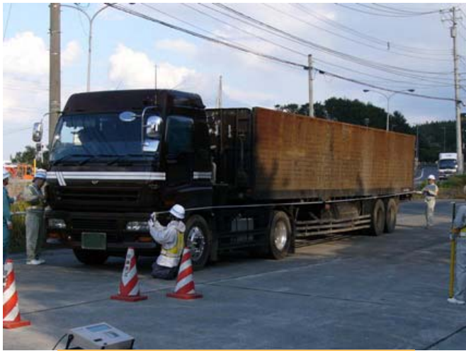
車両の全長計測を行っています
