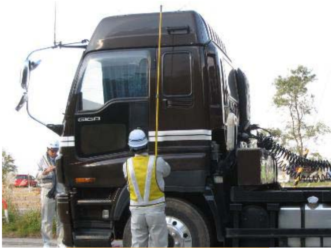
最後に全高を計測します
