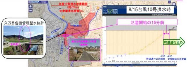
高知県高岡郡越知町では、仁淀川水系久万目川に設置された危機管理型水位計の水位情報を活用し、町道が浸水する前(氾濫開始水位到達15分前)に通行止めを実施
