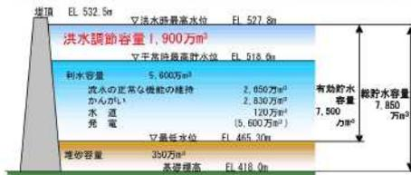
新たに1,900万m³の洪水調節容量を確保
