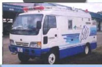
災害が発生した場合に、現地での通信確保及び情報収集を行うことを目的として、衛星通信設備を搭載し、日本国内のほぼ全域での画像や音声の通信を確保することができます。
