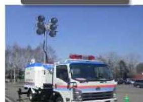
四輪駆動のベース車両に、発動発電機・照明装置・電源供給ケーブル等を搭載し、高さ約10mからの照明により夜間の復旧作業を支援します。
