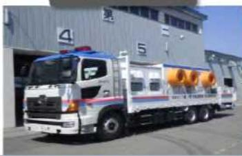
洪水災害時の排水作業を行う機械です。ポンプ・発動発電機・照明装置・その他用具一式を搭載しているので、ポンプの設置から排水までの作業を1台で行うことが出来ます。排水能力60m<sup>3</sup>/分
