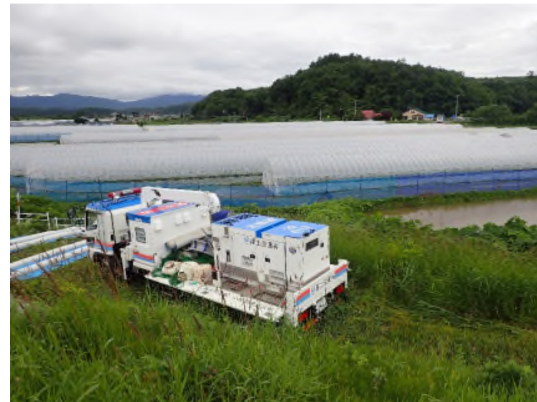
蘭越町からの要請により派遣された排水ポンプ車
