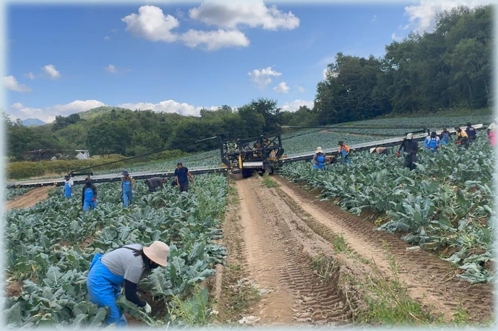
佐々木さんが独自開発した収穫機 両翼の幅は約30mにもなります！
