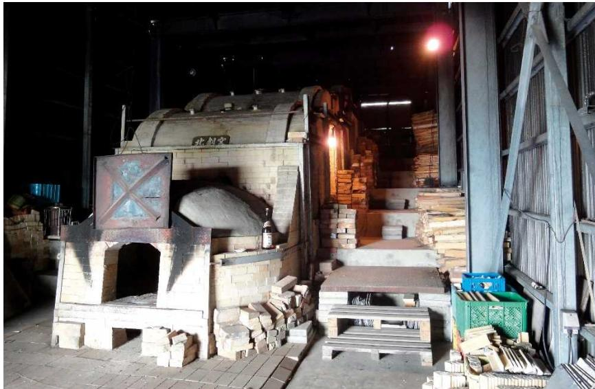
登り窯とは陶磁器などを大量に焼成するために、炉の内部を各間に仕切り、斜面などの地形を利用して、重力による燃焼ガスの対流を利用し、炉内を一定の高温に保つように工夫された窯のこと。焼き物の本質的な色合いや風合いを引き出すには最適で、もっとも生産効率のよい窯と言われています。しかし、建設費が高額なこともあって、北海道では札幌など5カ所にしか存在していません。そのうちの一つが、平成10年(1998年)に完成した小平町の「北創窯」。場所は小平町市街の北を流れる小平藻川の河口近くで、付近にはゆったりかん、ゆうゆうそう等宿泊施設もあります。
