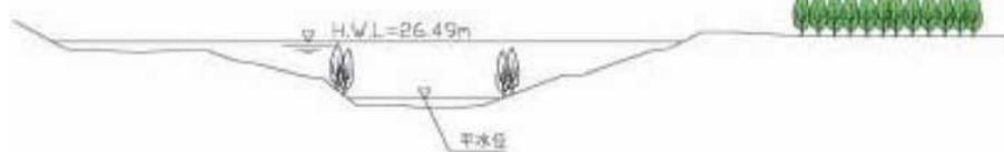
側帯及び河畔林の整備の横断面図イメージ図
