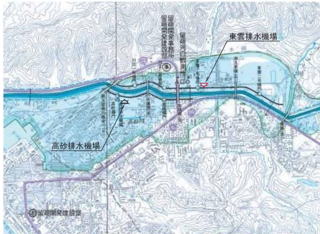
図 2 - 8 内水排除施設箇所図 (S=1:25,000)
