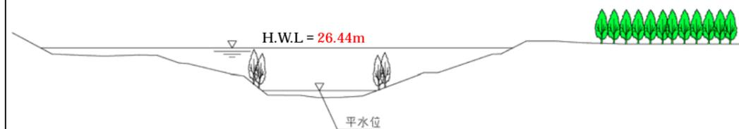
側帯及び河畔林の整備の横断面図イメージ図
