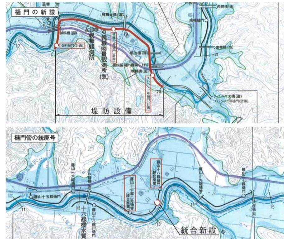
図 2-9 樋門管の新設・統廃合箇所 (S=1:25,000)
