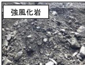
原石掘削は、地質調査結果をもとに堤体材料に使用可能な岩石(岩質)と、堤体材料に適さない強風化岩(強度の弱い脆弱な岩質)を確認し、掘削範囲を想定しています。
