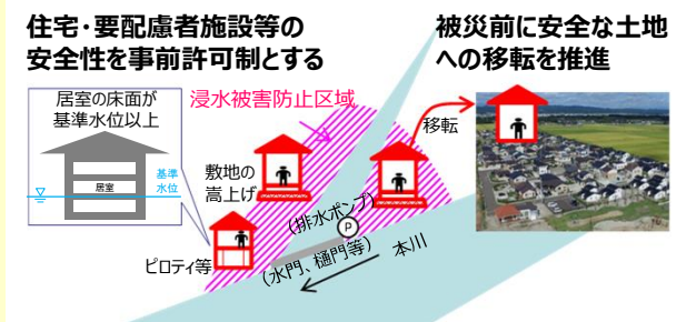
浸水被害防止区域における 居住誘導・住まい方の工夫イメージ
