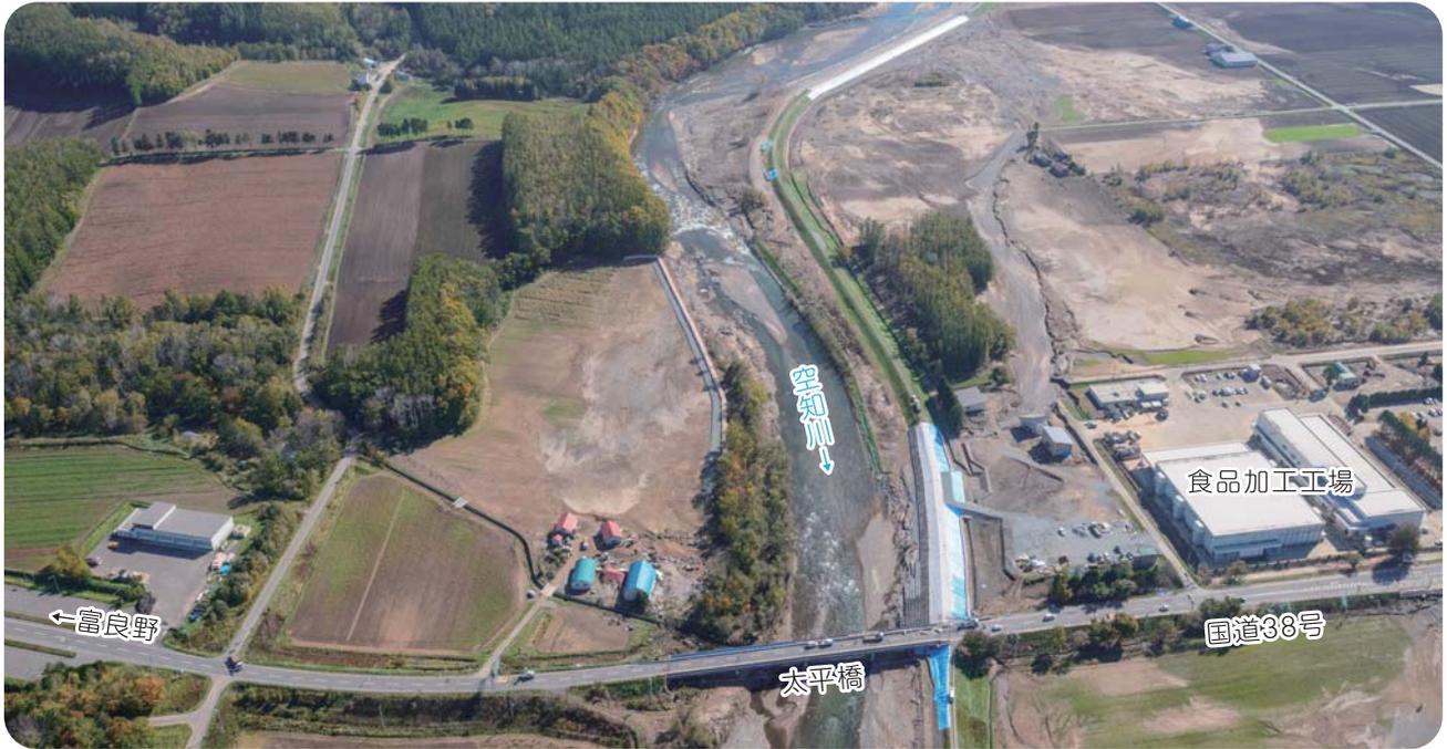
下流の堤防決壊箇所において、24時間体制で昼夜通した工事を行い、仮堤を造成し根固ブロックで補強を行い次期出水に備えました。(空知川幾寅築堤下流緊急応急復旧工事～大北土工工業株式会社施工)
