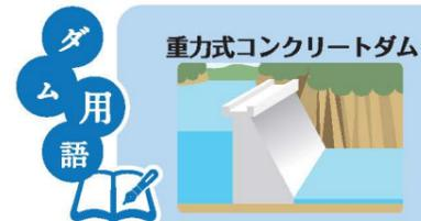
**重力式コンクリートダム** 重力式コンクリートダムは、ダム自体の重さによって水圧を支えるのが特徴です。横から見ると基本的に三角形の形になっています。ダムとしてはもっとも頑丈な型式で、地震や降水量の多い日本に適しています。夕張シューパロダムの下流にある川端ダムもこの型式でつくられています。材料はコンクリート。コンクリートには、セメント・水・砂・砂利などが使われます。砂や砂利のもととなる岩は、近くの山や川から採取します。
