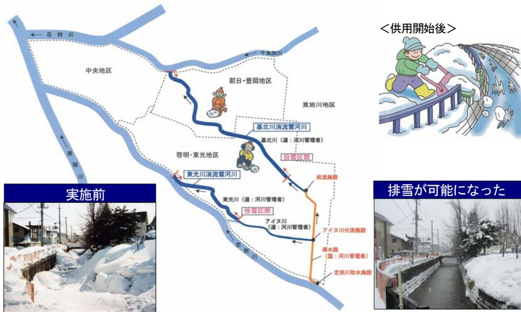
図 1-11 消流雪用水導入事業概要図
