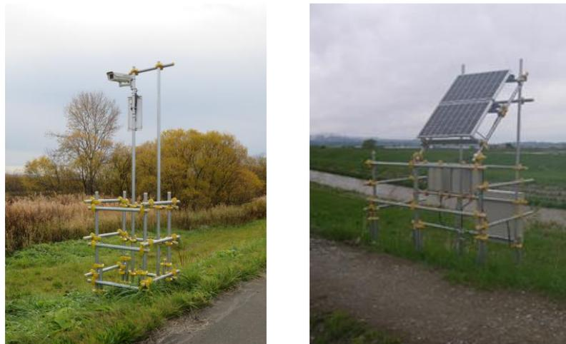
図 2-5 簡易型河川監視カメラ(左)、危機管理型水位計(右)
