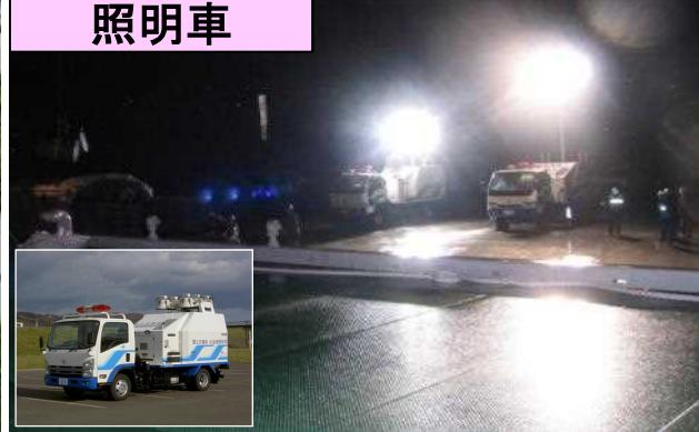
夜間の災害現場における作業員の安全確保や、被災現場の監視を行う際の照明として使用します。
