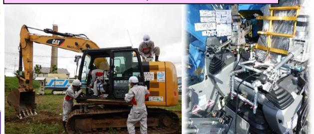
火山災害や土砂災害など危険な箇所では、汎用のバックホウにこの装置を装着して、遠隔操作による災害復旧作業が可能です。
