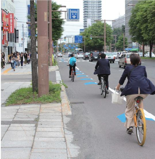
原則10m間隔で矢羽根型路面表示を配置します
