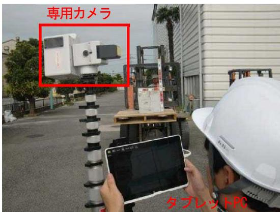
点検専用カメラと操作端末(タブレットPC)
