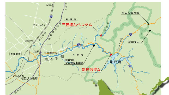
Mikasa ponsersu dam 三笠ぽんべつダム【建設中】 奔別川に新たに建設する三笠ぽん べつダム。普段は水をそのまま流下 させ、洪水時のみ一時的に流水を貯 留する流水型ダムとして流域の安全 を守ります。
